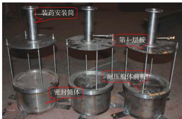
图2 模拟典型结构图
