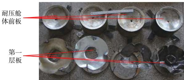
图6 实验后靶板的破坏情况
